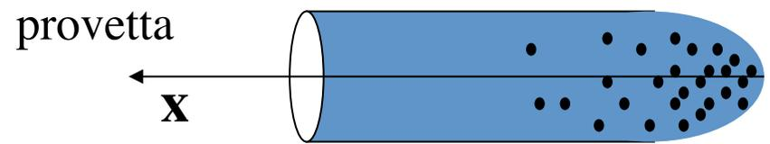
In questo caso alla forza peso ( $P=mg$ ) si sostituisce la forza centrifuga ( $C=mg_{\text{eff}}$ , dove  $g_{\text{eff}}=R\omega^2$  con  $R$  raggio della centrifuga).
